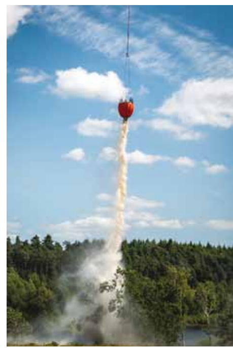
2000 liter vand kan enten spredes over et større område eller et enkelt punkt.
