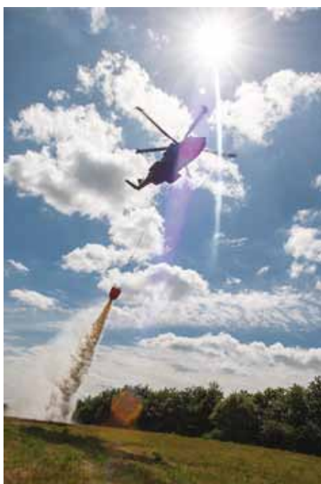
2000 liter vand dumpes fra helikopteren i forsøgsopstillingen.
