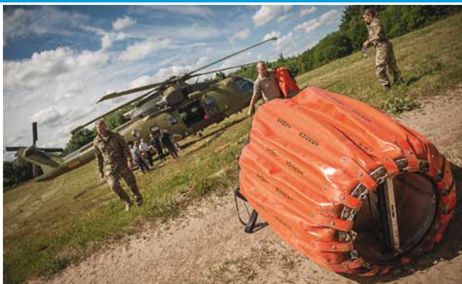
"Spanden", som anvendes til brandslukning, hedder Bambi-Bucket, og fås i forskellige størrelser. Den Flyvevåbnet råder over indeholder 2000 liter. Foto: Rune Dyrholm
